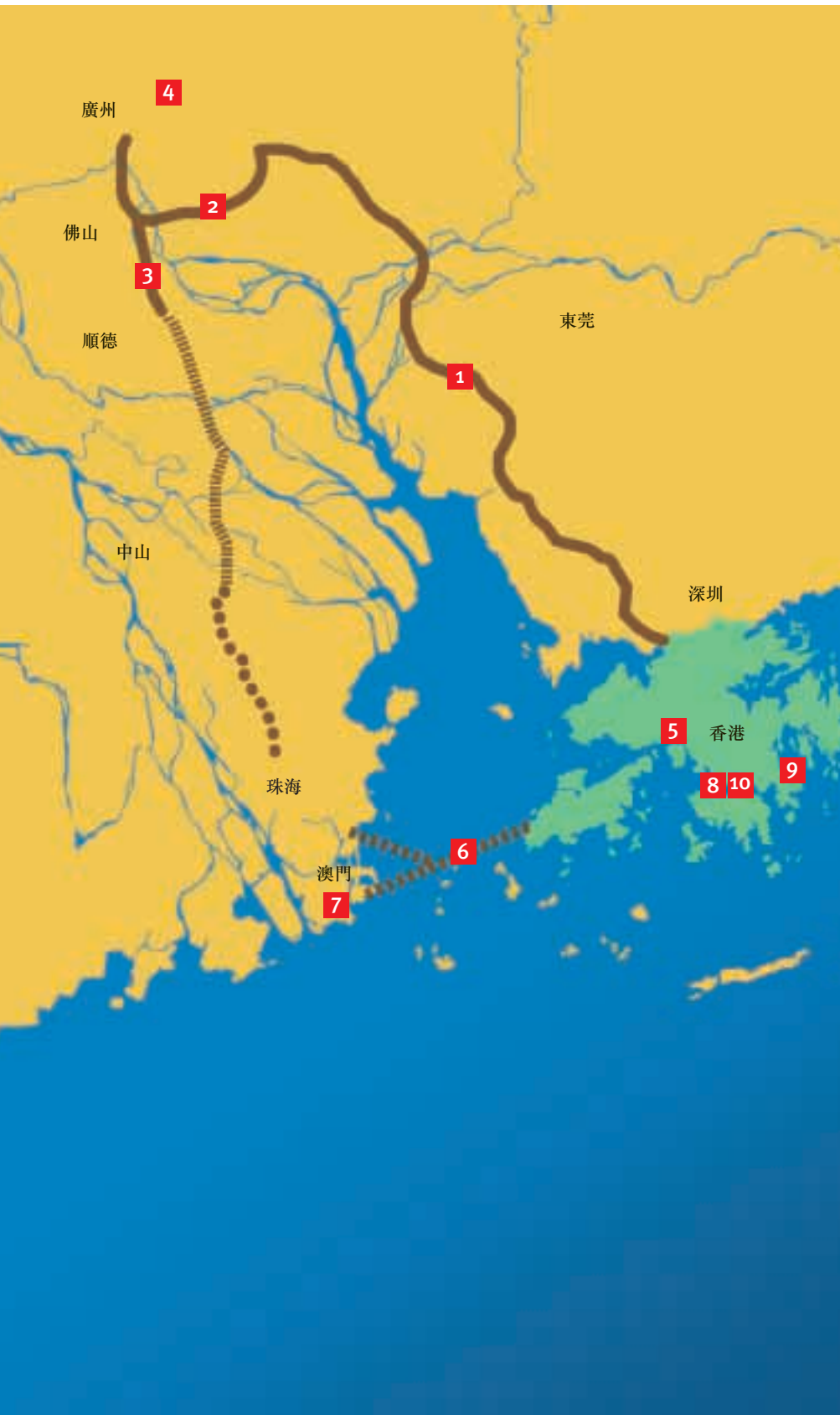
1 廣州 - 深圳高速公路 全線總長 122.8 公里封閉式瀝青鋪設之雙向三車道高速公路，由深圳市皇崗至廣州市廣氮，連接廣州東南西環高速公路。
